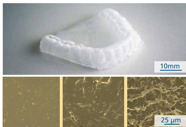
1 Aufbisschiene (Knirscherschiene) aus Ethylen-Vinyl-Copolymer (oben). Rasterelektronenmikroskopische Aufnahmen der Materialoberflächen einer Aufbisschiene nach verschiedenen Reinigungstests (unten): mit Tablettenreinigung (links), mit Desinfektionslösung (Mitte), mit Zahnbürste und Zahnpasta (rechts).
