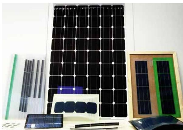
*1 Auswahl an Sondermodulen hergestellt am Fraunhofer CSP, unter anderem verschiedene Kunststoff- und Naturfasermodule.*
