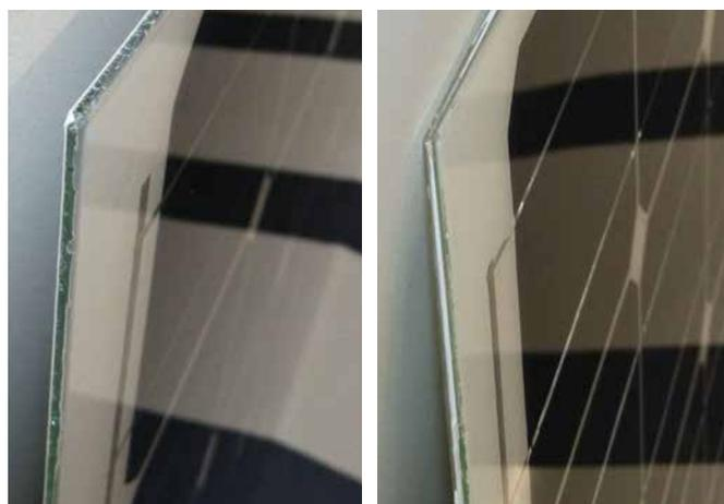
1 Aufnahmen der Ecken eines ungerahmten Standardmoduls mit einer Glasdicke von 3,2 mm (links) und eines mit Industriepartnern weiterentwickelten Glas-Glas-Moduls mit einer Glasdicke von je 2 mm (rechts).
