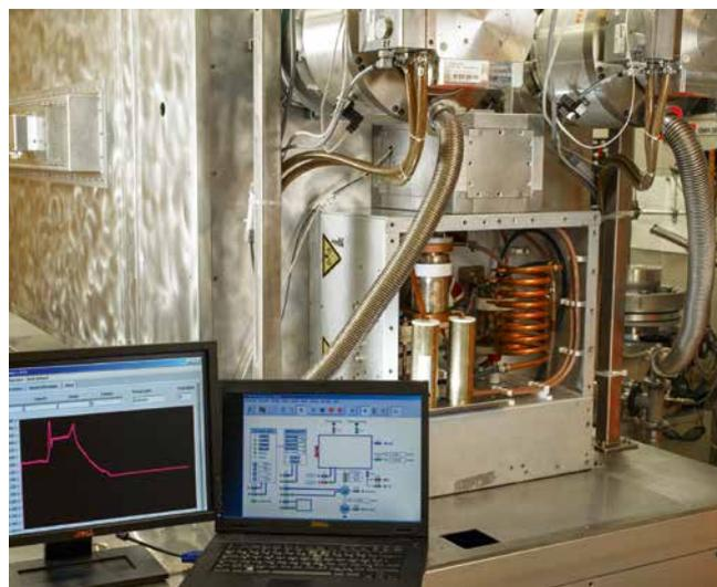
1 Weiterentwickeltes Anpassnetzwerk der PECVD-Anlagentechnik sowie Benutzeroberfläche des Plasma- und HF-Monitors.
