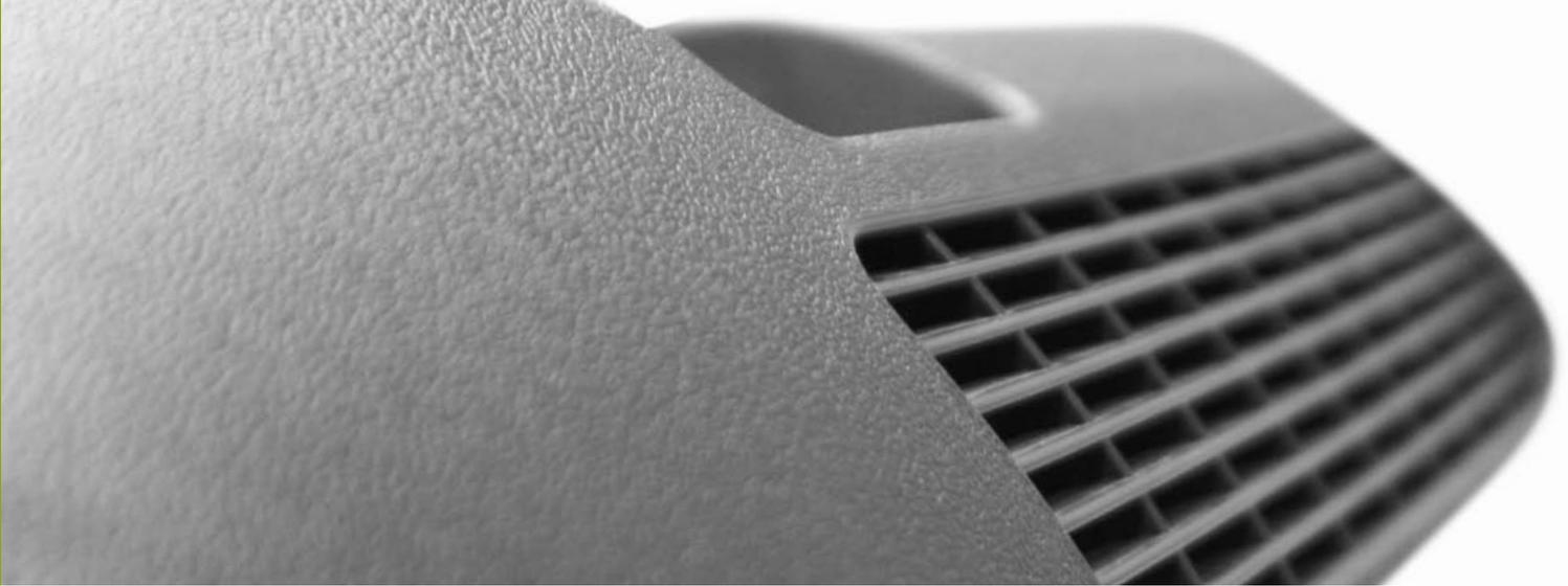
Spritzgegossenes Strukturbauteil aus einem am Fraunhofer IWM entwickelten Polyamid-Compound.
