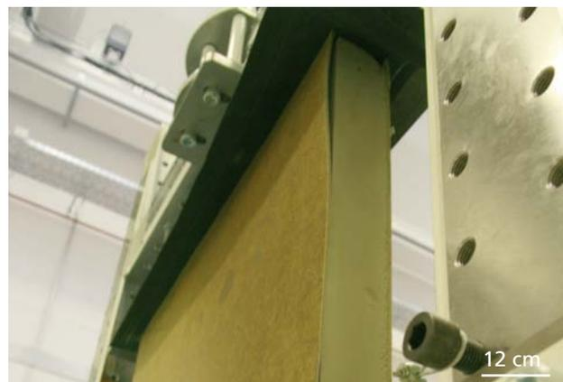
1 Thermisch isolierendes Architekturelement im Beultest.
