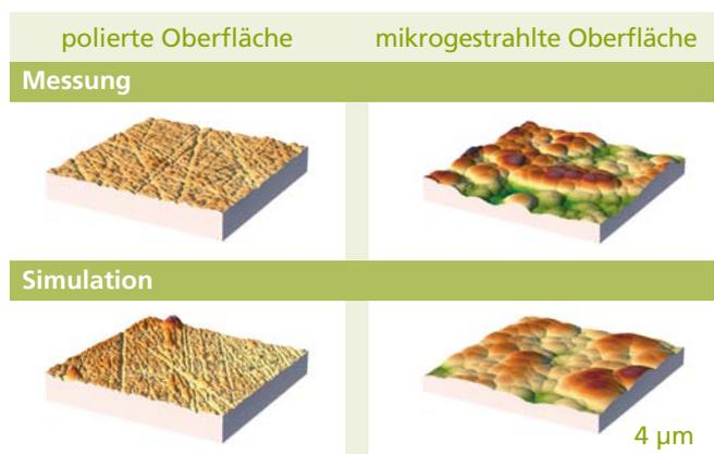
1 Oberflächenstruktur einer schwach strukturierten Schicht auf polierter Oberfläche (links, zehnfach überhöht) und einer stärker strukturierten Schicht auf mikrogestrahltem Substrat (rechts), jeweils mit Rasterkraftmikroskop gemessen (oben) und aus der Simulation (unten).
