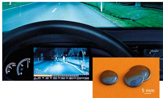
1 Infrarot-Nachtsichtsystem in einem Pkw: Die Chalkogenidlinsen (rechts) sind in der Optik der Infrarot-Nachtsichtgeräte integriert.
