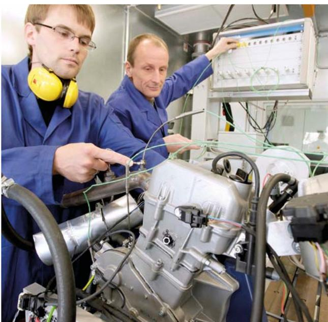
1 Einzylinderforschungsmotor zur Messung von Reibung und Verschleiß.
