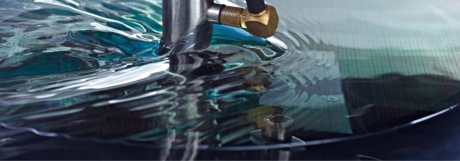
*Akustisches Rastermikroskop beim Scannen eines prozessierten Wafers.*
