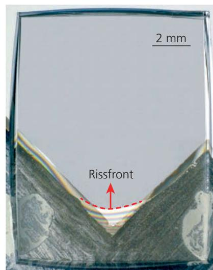
1 Nach dem Heißformgebungsprozess am Formenmaterial an-klebende Glasprobe mit gestartetem Trennriss in der Grenzfläche zwischen Glas und Formenmaterial (Markierung).
