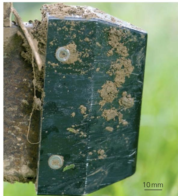
1 DLC-beschichtetes Schneidwerkzeug unmittelbar nach dem Einsatz.
