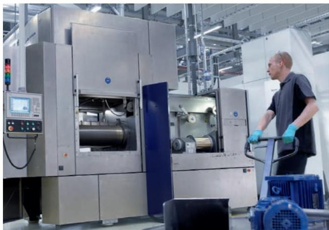
1 Industrie-Multidrahtsäge zur gleichzeitigen Herstellung von mehreren Tausend Wafern.
