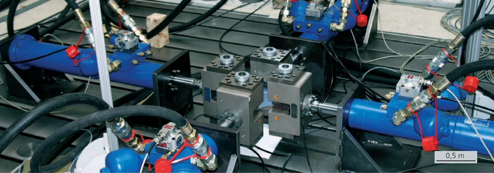
Biaxialer Prüfaufbau mit Kreuz-Zugversuch.
