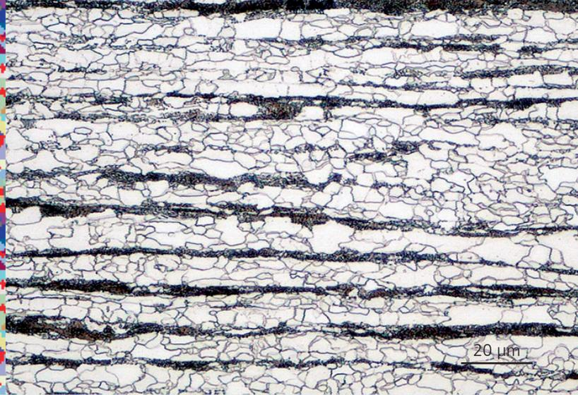
Generierte Mikrostruktur des Warmbandes unter Berücksichtigung der statistischen Phasenverteilung des realen Werkstoffs.
