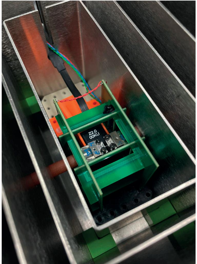
*Zug- und Ermüdungsaufbau in der im Projekt »QMag« entstandenen magnetischen Abschirmung.*
