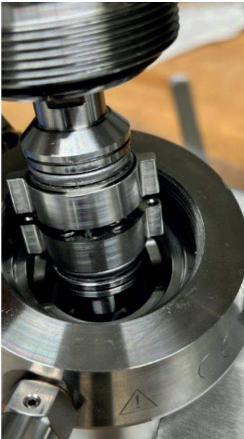
1 Wälzlagerprüfstand in einer Hochdruckkammer für Versuche in Wasserstoff.
