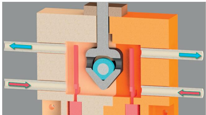
1 Welle-Buchse-Kontaktstelle im Schnitt mit vertikalem Probenhalter zur Normkrafteinleitung, thermischer Einhausung (orange Gehäuse), Konvektionsheizern (rot) und Rohranschlüsse zur Atmosphäreneinleitung.
