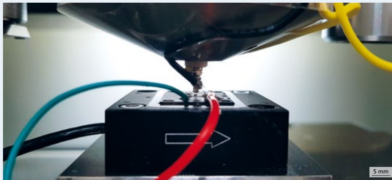
1 Versuchsaufbau mit Positionierer (unten) und der Belastungseinheit am Nanoindenter (oben).
