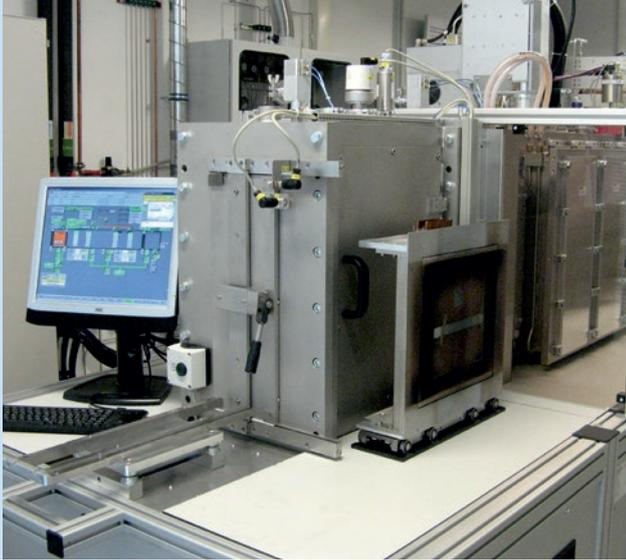
*Große Beschichtungsanlage, beispielsweise für diamantähnliche Kohlenstoffschichten DLC (2006).*
