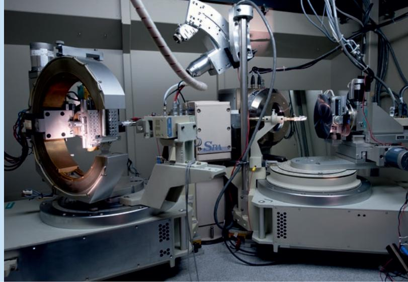
*Röntgendiffraktometer: Zerstörungsfreie Ermittlung von oberflächennahen Eigenspannungen, Phasenanteilen und Texturen (2015).*
