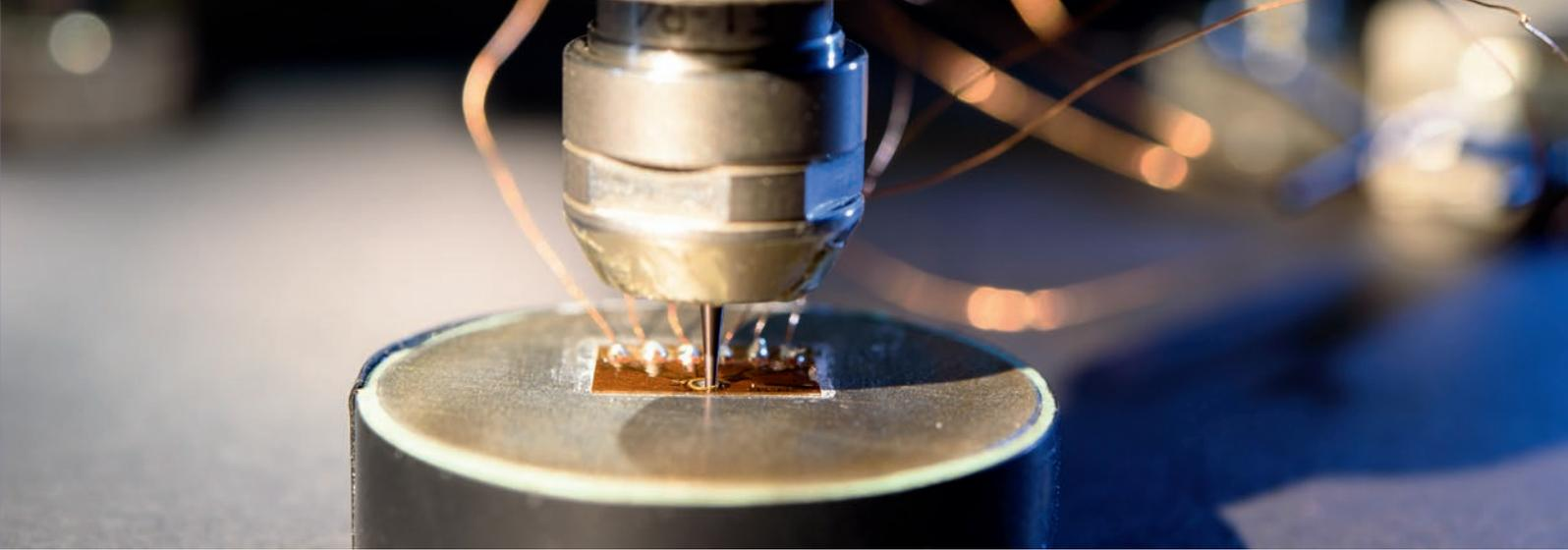
*Ein nützliches Standardverfahren zur Bestimmung von Eigenspannungen in Proben: die inkrementelle Bohrlochmethode.*
