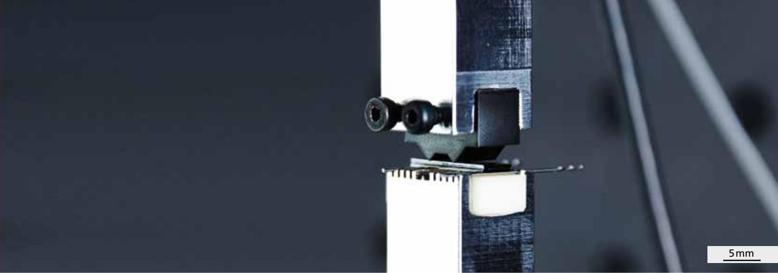
3 Foto einer Mikrobiegeapparatur. Es können Drei- und Vierpunktbiegeexperimente mit variablen Lagerabständen realisiert werden.
