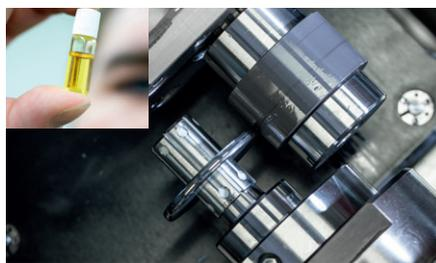
Bislang ging der Einsatz niedrigviskoser Spezialschmierstoffe auf Kosten der Lebensdauer von Motoren, Getrieben und Lagerungen. Bei flüssigkristallinen Schmierstoffen ist dies kein Thema, im Gegenteil: Bei der hydrodynamischen Schmierung werden die gegeneinander laufenden Oberflächen durch den Flüssigkeitsfilm komplett getrennt. Noch bei minus 20 Grad Celsius funktioniert die Schmierung.
