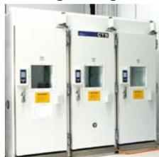
40-Tage-Prüfung entspricht etwa 20 Jahren in der Alltagsnutzung. Eine Besonderheit sind UV-Tests direkt in der Feuchte-Klimakammer, so genannte Tropentests, sowie Feuchte-Frost-Zyklustests. In Dreifachkammern lassen sich Paralleltests zur vergleichenden Materialanalyse und Lebensdauer vorhersage durchführen.
