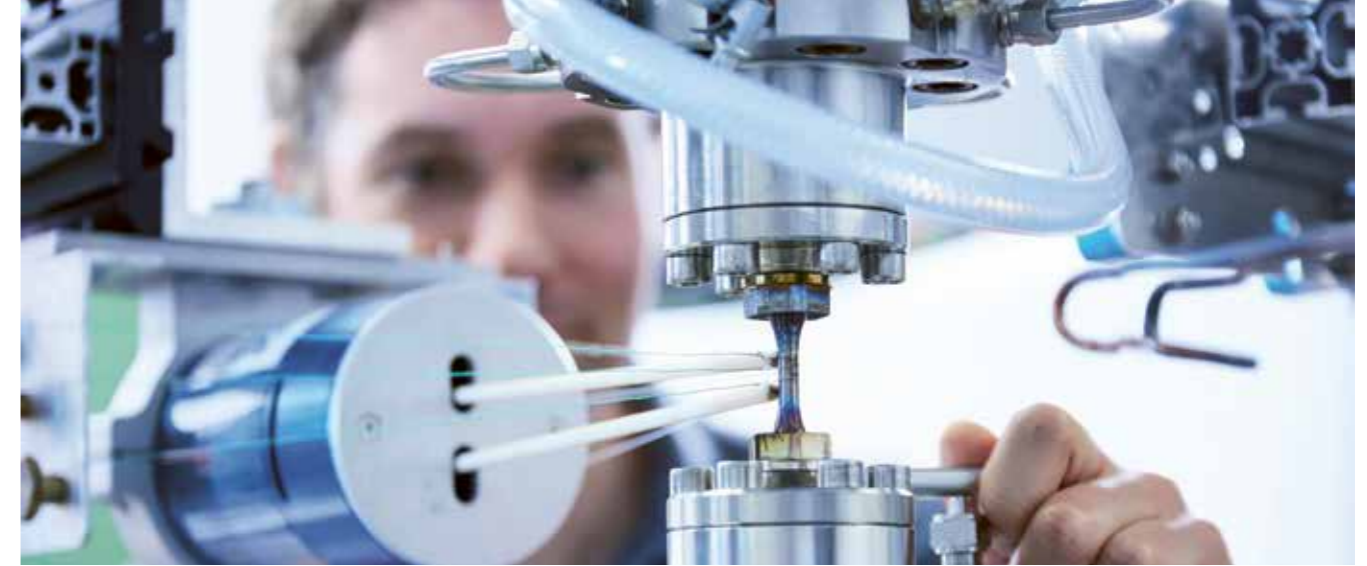
Abgekühlte Hohlprobe nach dem thermomechanischen Ermüdungsversuch.
