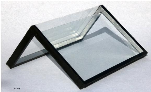
**Abb. 1 Mit dem neuen Glasbiegeverfahren hergestellter Prototyp einer Isolierglasscheibe.**
