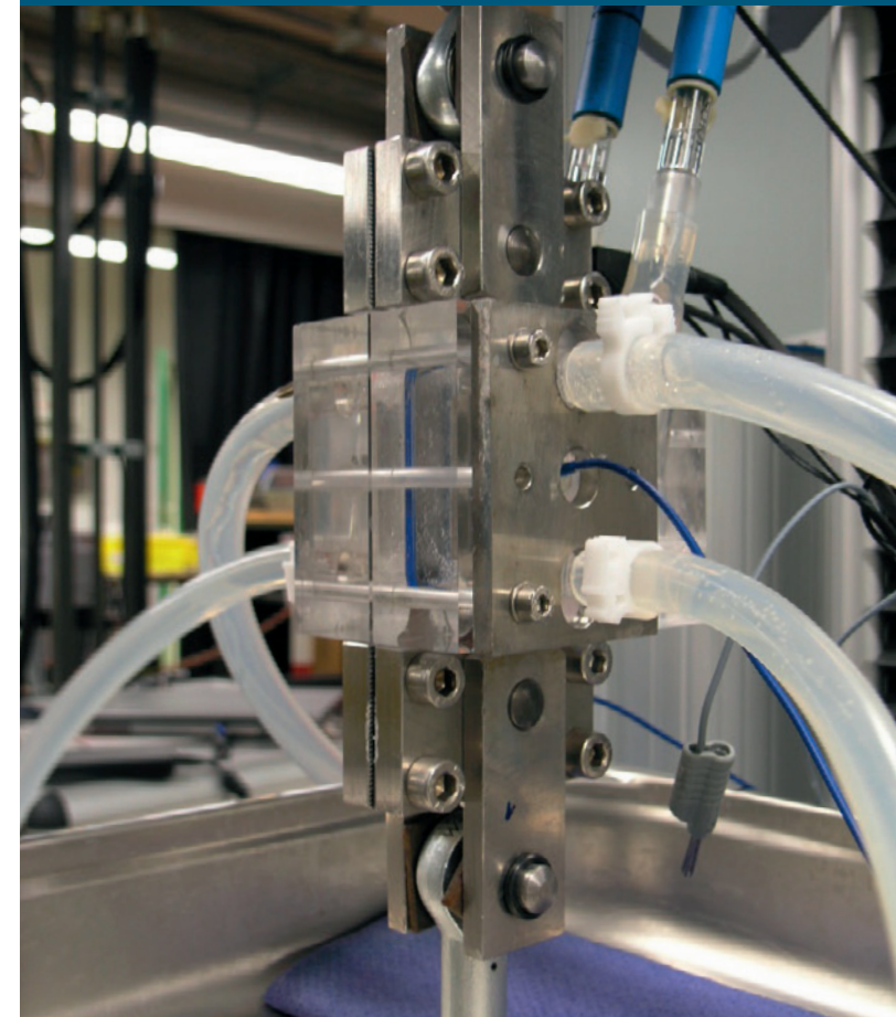
Coverbild: Zugprüfmaschine mit Zelle für die elektrochemische in situ Wasserstoffbeladung.
