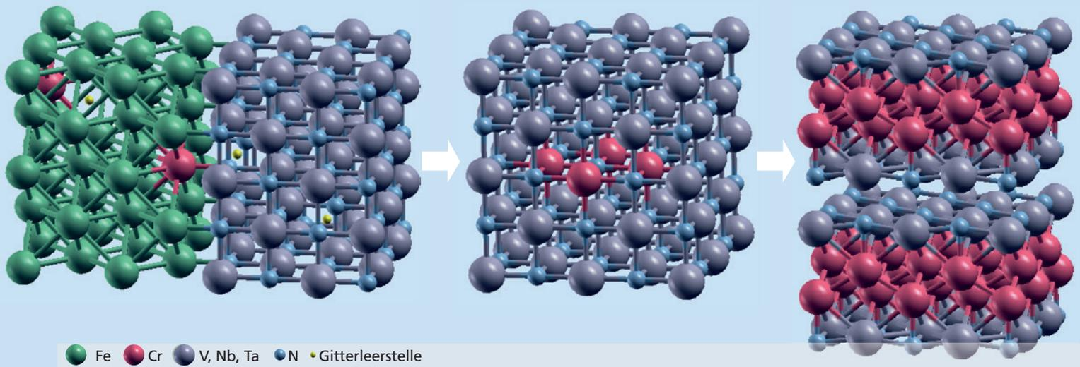
*Bildung der Z-Phasen-Ausscheidungen: Einzelne Cr-Atome aus der Fe-Matrix diffundieren in Metallnitridpartikel hinein (links), bilden flache Cluster (Mitte) und diese wachsen zu periodischen Schichten (rechts).*
