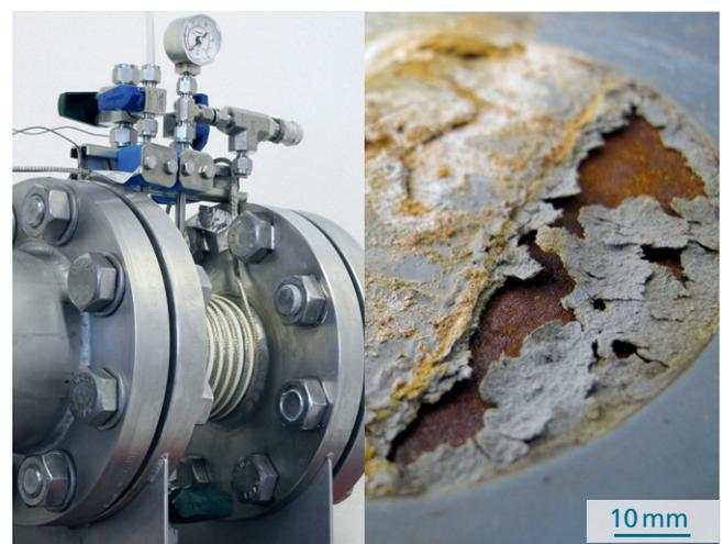
1 Prüfstand zur Bewertung von Korrosionsschutzbeschichtungen unter Berücksichtigung des »Cold Wall«-Effekts (links). Schichtversagen nach Auslagerung (rechts).
