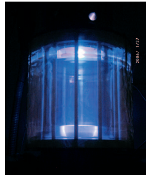
Abb. 1 Rezipient und Plasma während des Beschichtungsprozesses.
