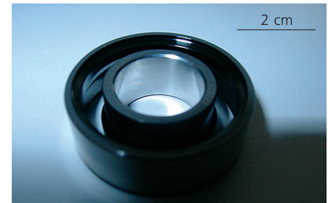
Abb. 3 DLC-beschichtete Innen- und Außenringe eines trockenlaufenden Hybridwälzlagers
