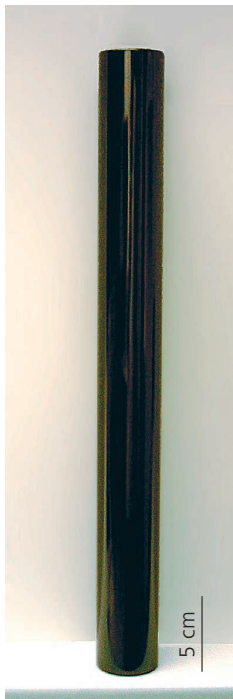
Abb. 2 DLC-beschichtete Azimutalrolle einer Segelflugwinde
