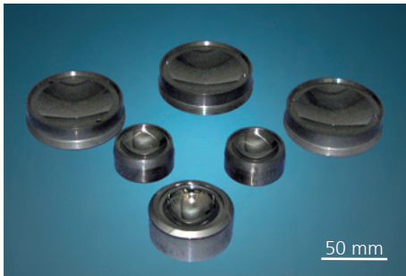
Abb. 1 Aufnahme von Formwerkzeugen, die mit einer Hartstoffschicht im PVD-Verfahren beschichtet wurden.
