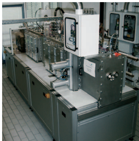
Abb. 1 Blick auf die Mehrquellen-Beschichtungsanlage.
