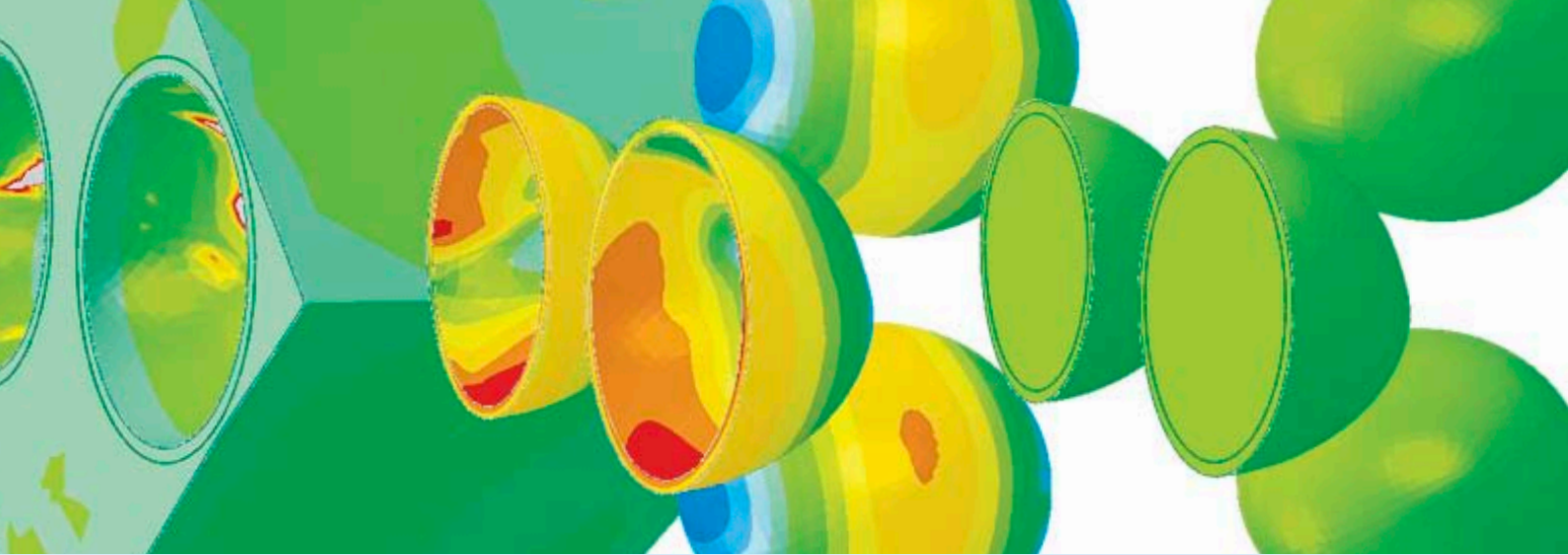
Die Aktivierung der Duftkapseln (Durchmesser 30 \mu\text{m} ) durch ein Aufreißen der Kapseln unter Last (rot) wurde über Komposit-Simulationen der Einzelmaterialien analysiert.
