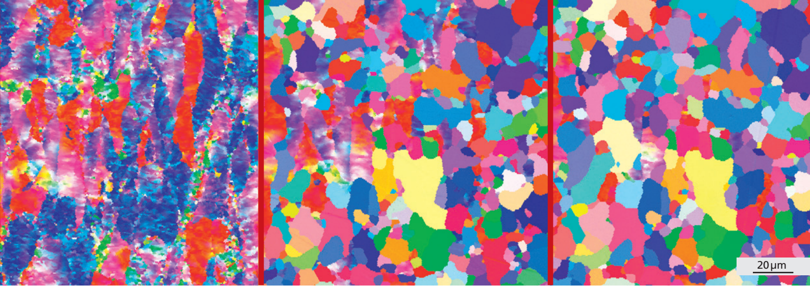
3 Rekristallisation von kaltgewalztem Stahlblech: EBSD-Aufnahmen zu Beginn (links), nach 20 s (Mitte) und nach 120 s (rechts).
