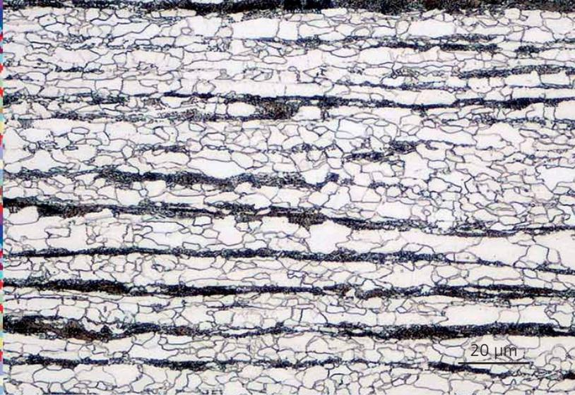
Generierte Mikrostruktur des Warmbandes unter Berücksichtigung der statistischen Phasenverteilung des realen Werkstoffs.
