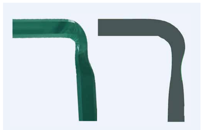
1 Im Experiment (links) und in der Simulation (rechts) erzeugter Knick bei 4 mm Glasdicke und einem Biegeradius < 5 mm, jedoch mit Einschnürung.
