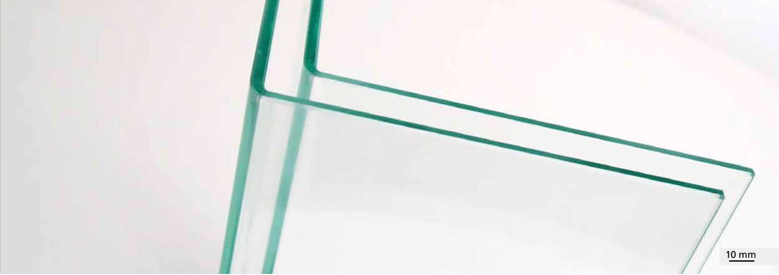
3 Zwei mit kleinem Biegeradius um 90° gebogene Flachgläser, Anordnung wie in einer Isolierglasscheibe: 12 mm Abstand.
