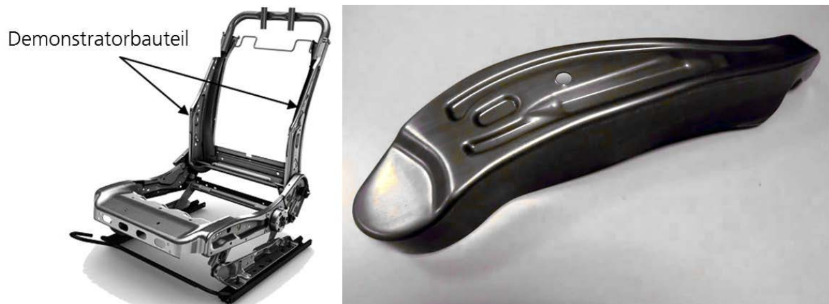
Bild 3: Als Demonstratorbauteil wird ein Seitenteil der Sitzlehne betrachtet (links). Aus TWIP-Stahl hergestelltes Demonstratorbauteil (rechts) © Faurecia Autositze GmbH (beide Abbildungen).
