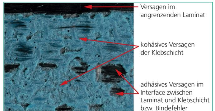
2 Gemischte Versagensmechanismen einer geklebten CFK-Probenvorrichtung nach dem DCB-Versuch.
