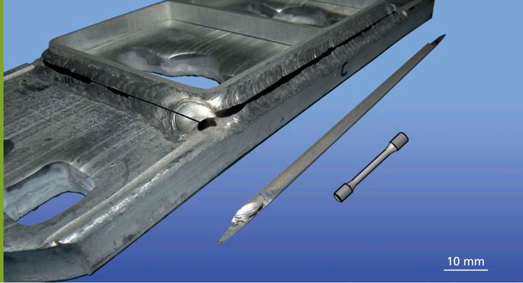
Mit Drahterosion aus der Schweißnaht herauspräparierter Rohling und daraus gefertigte Mini-Rundzugprobe mit etwa 1,8 mm Prüfdurchmesser.
