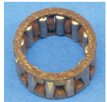
Korrosion an Lagern: Abhilfemaßnahmen?
