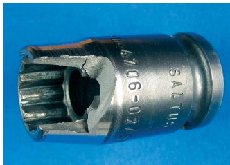
Bruchursache an einer Schraubennuss: Einsatz oder Fertigung?
