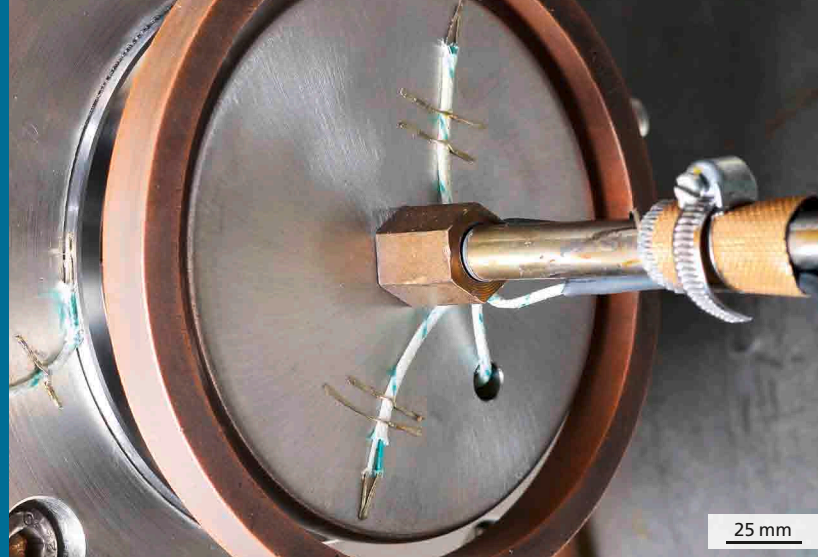
Maßgeschneiderter Versuchsstand zur Verschleißmessung an großen Ventilen unter definierten Belastungen (links), Ventil im Versuchsstand (rechts).
