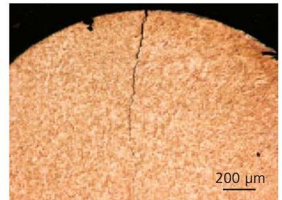
Abb. 1 Querschliff eines Wolframdrahts mit Split.
